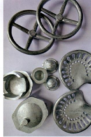
Einige der bereits fertigen Gussteile aus Schleuderguss
